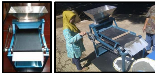
Gambar 1.3 Mesin pemisah pasir besi menggunakan air dan magnet permanen
